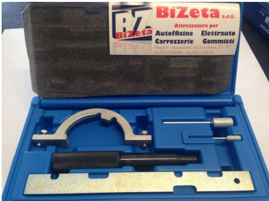
**KIT MESSA IN FASE MOTORI OPEL 1.0/1.2 16V A 3 CILINDRI** così composto:
